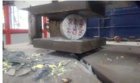
Fig 5: Split tensile test
