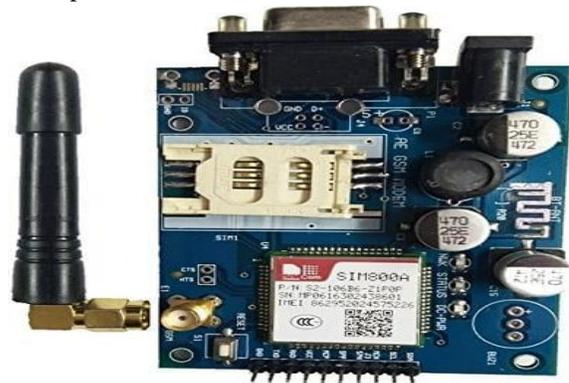
Fig.4.4 SIM800A GSM Module
