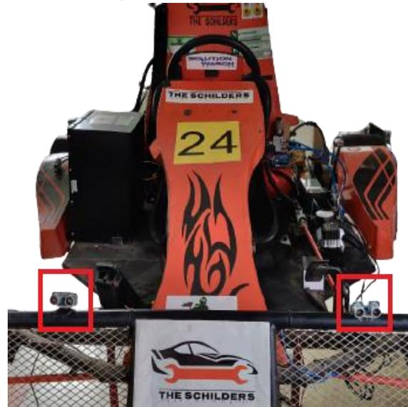
FIG 4 : SENSORS POSITIONING
